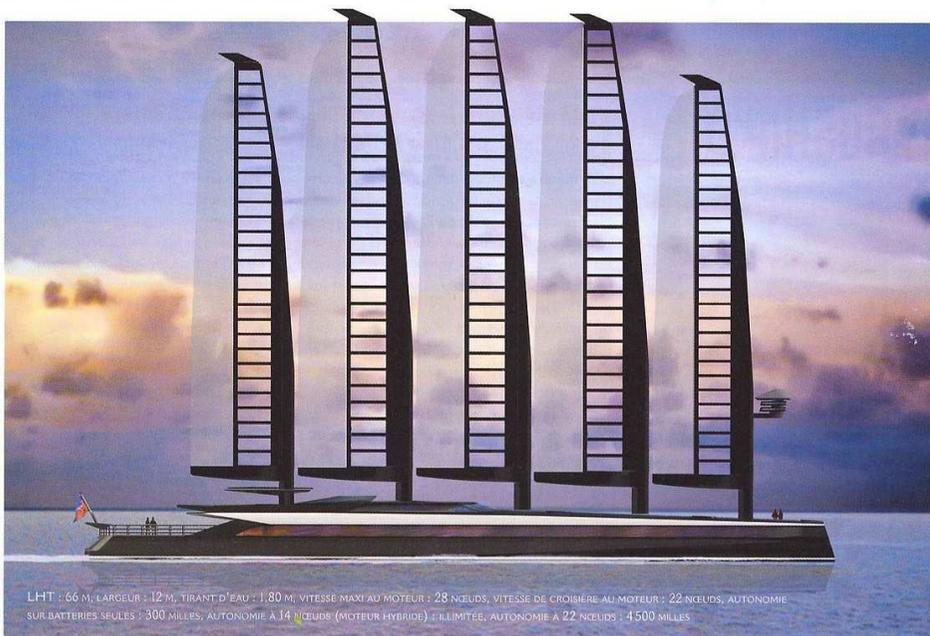
L.H.T. : 66 M, LARGEUR : 12 M, TIRANT D'EAU : 1,80 M, VITESSE MAXI AU MOTEUR : 28 NŒUDS, VITESSE DE CROISIÈRE AU MOTEUR : 22 NŒUDS, AUTONOMIE SUR BATTERIES SEULES : 300 MILLES, AUTONOMIE À 14 NŒUDS (MOTEUR HYBRIDE) : ILLIMITÉE, AUTONOMIE À 22 NŒUDS : 4 500 MILLES
